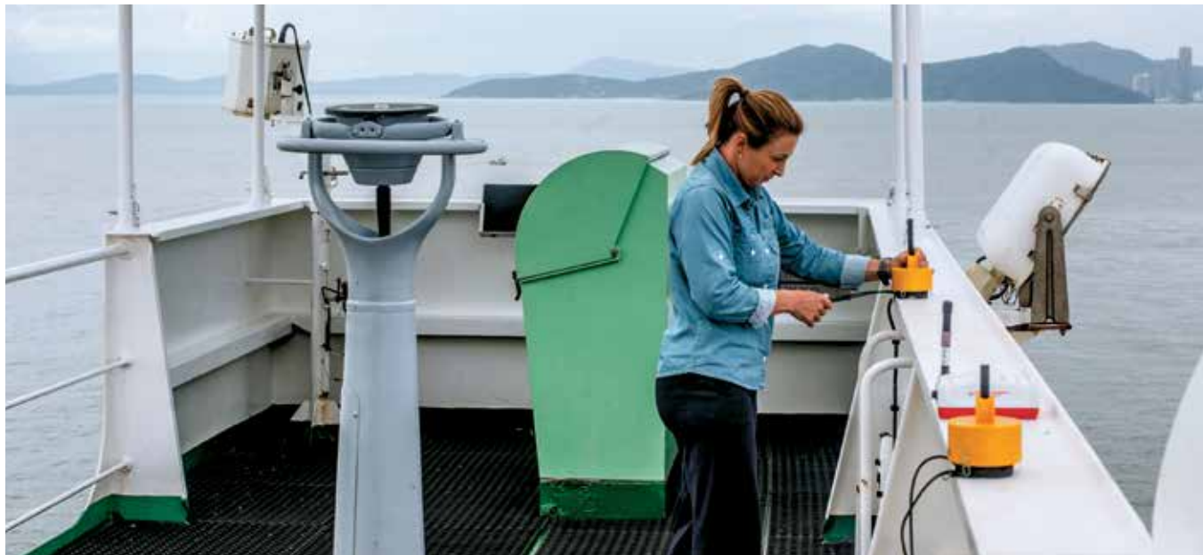
PRÁTICA LIVIA LAGE INSTALANDO ANTENAS DO PPU NA ASA DO NAVIO
